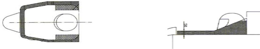
A fin de delimitar la altura lateral de la carlinga en la abertura del habitáculo se deberá colocar una regla tangente entre el arco principal y el arco delantero, partiendo desde el apoya cabeza hacia delante por 300mm se deberá mantener una altura vertical entre la carlinga y la regla de 220mm.
